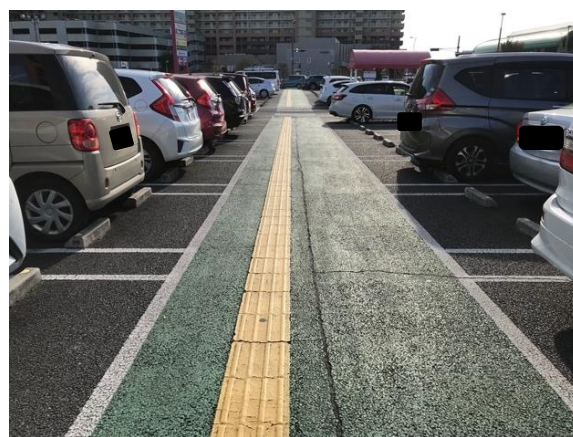
写真4. 地面と明確に色分けされた歩行者通路(ピアシティみらい平)
