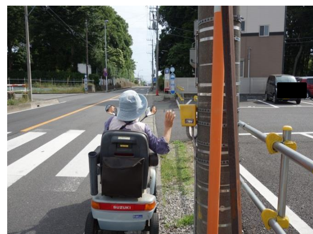
図 6. 押しボタン機のボタンを押すには車道にはみ出す可能性がある
