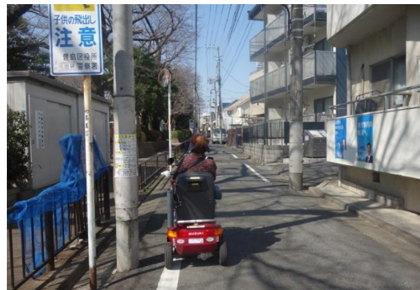
図 4. 路側帯に電柱があり走行困難
