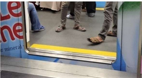
写真 12. プラットホームと車両乗降口との 段差と隙間
