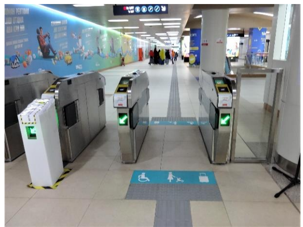
写真 15. 幅の広い改札口に点字ブロックが設置されている
